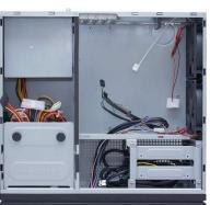
「NSK2450B」はユニークな三部構造により、電源/マザーボード/ハードディスクを別々のユニットに隔離し、システムからの熱伝導を防ぐと共に動作音を抑制します。さらに振動ノイズを抑える静音技術を各ユニットに施しています。 電源/光学ドライブユニットと梁(筐体)には、接地面に対して振動防止ゴムグロメットを装備し、ハードディスクユニットには、シリコンクリップとシリコングロメットを備え、振動を吸収しノイズを低減いたします。 エアーフローにも優れ、マザーボードユニットには速度調節が可能な 120mm ファンを 2 基搭載し、電源/ハードディスクユニットには通気窓を採用しています。また効率のよいエアーフロー環境を実現するために、電源コネクタ類/フロントコネクタ類/ハードディスク電源コネクタ類のケーブルマネージメントを行うことができます。
