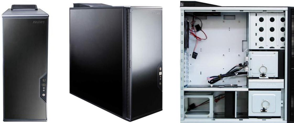
P182 は、ケース内を上下に隔離したデュアルチェンバー構造を採用しています。システム内の熱伝導を防ぎ、排熱ゾーンを分離いたします。より効果的なエアフローを実現し、発熱とシステムノイズを低減いたします。ケース上部には CPU/マザーボード/VGA カード/HDD、ケース下部には電源/HDD を設置できます。ケースのサイドパネルには、プラスチックをアルミで挟み込んだ(アルミ+プラスチック+アルミ)三層の遮音パネルを採用しています。ケース内のノイズをしっかりと遮断し、共振や音もれを防ぎます。
