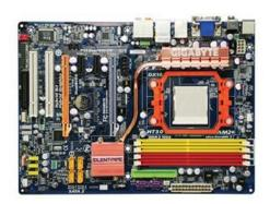
主な対応インターフェースは、2 倍の帯域幅を実現する次世代バス規格 PCI Express 2.0 に対応した PCI Express x 16 スロット、高速な DDR2 - 1066MHzメモリをサポートするデュアルチャンネル対応のメモリスロット、1000Mb/秒のギガビット LAN、3Gb/秒の SATAII になります。高速なデータ転送環境を実現いたします。
