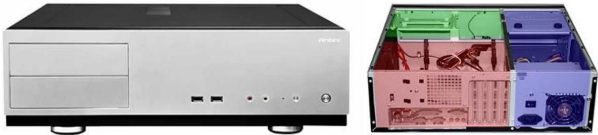
エアフローにも優れ、マザーボードユニットの排気用 120mm ファンにより、筐体内を陰圧に保ちます。各エアインテーク(吸気窓)から、つねに新鮮な空気を取り込み、CPU/ハードディスク/マザーボード/グラフィックスカード周辺を効果的に冷却いたします。また各種ユニットの仕切りには、電源ケーブル用の穴を備え、エアフローの障害となる電源ケーブルを効果的にまとめることができます。
