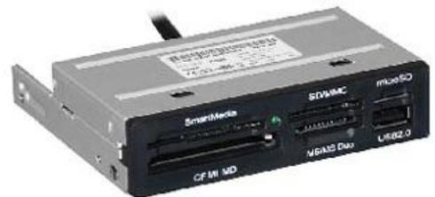
携帯電話などに使用されているマイクロSD(MicroSD)も変換アダプタ無しで、そのまま利用できます。さらにUSBコネクタも搭載していますので、USBメモリなどUSB周辺機器も利用できます。
