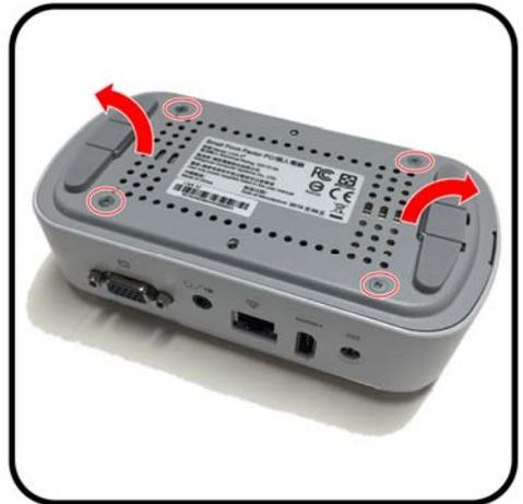
2. ヒートシンク部分の4点のねじを外し、ヒートシンクを外します。
