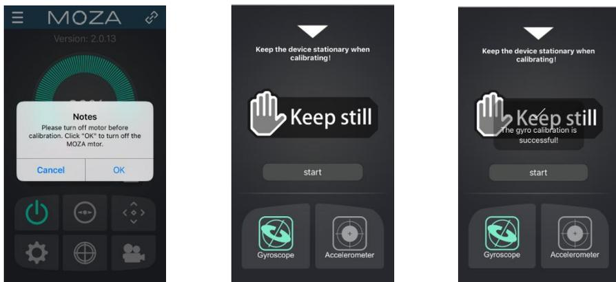
デバイスページの“Gyroscope/Accelerometer Calibration”ボタンをクリックします。上記の表示が出ます。“OK”ボタンをクリックしてキャリブレーションに進みます。
