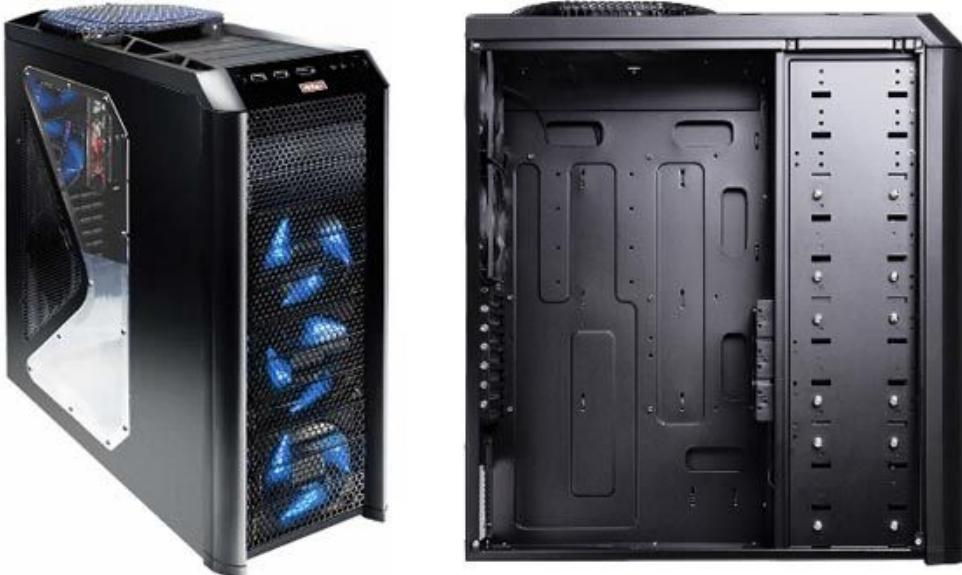
Twelve Hundred は、合計で6つの冷却ファンを搭載しています。トップに200mm TriCool ブルーLEDファン(3段階に速度調節可能)を1つ、リアに120mm TriCool ブルーLEDファン(3段階に速度調節可能)を2つ、フロントに120mm TriCool ブルーLEDファン(3段階に速度調節可能)を3つ搭載しています。
