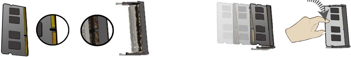
※ メモリがロックすると両端の爪がメモリにかかります。メモリを取り外す場合にはメモリスロット両端にあるロックを外側に開けばロックが解除されメモリが持ち上がります。
