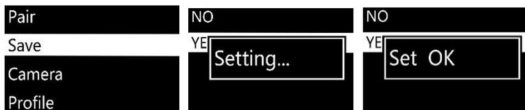
保存を確認して、OLED ディスプレイに“Set OK”と表示されます。“Set ERR”と表示された場合は、再度保存のステップを試してください。
