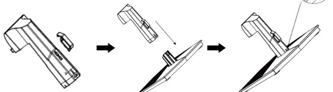
3. 液晶パネル面を下に向けたまま液晶パネル背面の下部に台座を接続し、台座がしっかりと固定されている事を確認してください。モニターを持ち上げる際液晶の画面部分に触れぬようご注意ください。
