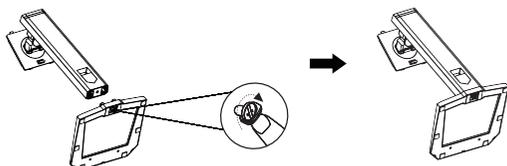
3. 組み立てたスタンドとベースを、液晶パネル面を下に向けたままパネル背面の中央の窪みにはめ込みます。スタンドのツメがパネル背面と合うように斜めに挿入し固定してください。モニターを持ち上げる際、液晶の画面部分に触れないようご注意ください。
